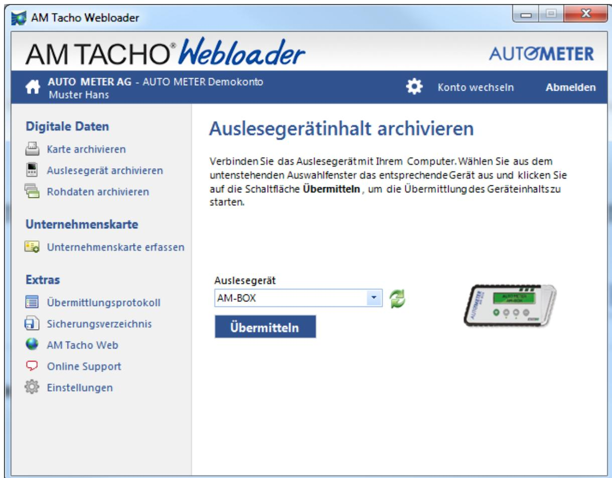
Mit der Funktion "Auslesegerät archivieren" kann der Inhalt der bekannten Auslesegeräte wie AM-Box, Optac, TachoDrive und Siemens DownloadKey übermittelt werden. Alle am Computer angeschlossenen Auslesegeräte erscheinen im Dropdownfeld und können ausgewählt werden, wie hier im Beispiel eine AM-Box. Mit Hilfe der grünen Pfeile kann die Anzeige der angeschlossenen Auslesegeräte aktualisiert werden.
